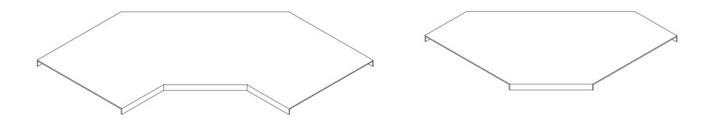
CABLE TRAY/LADDER COVER HORIZONTAL ELBOW 2.45°
