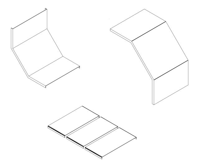
CABLE TRAY/LADDER COVER VERTICAL ELBOW
